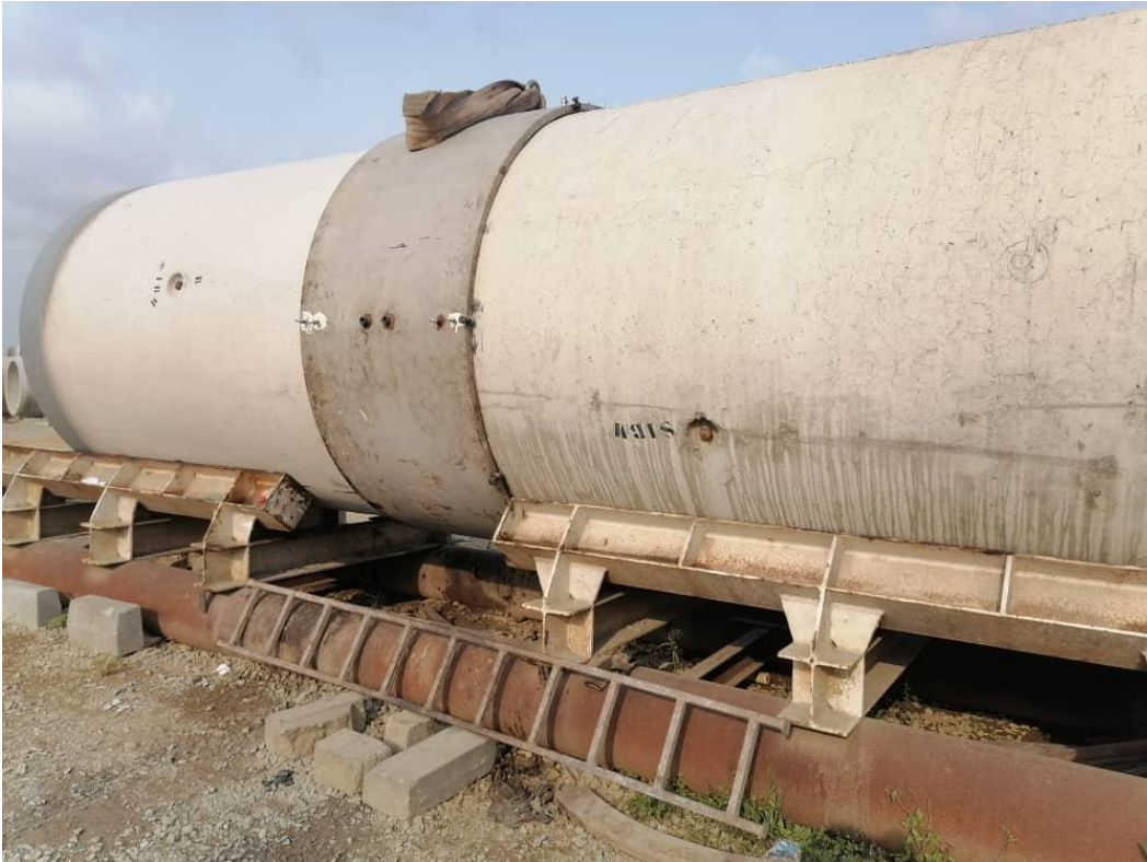
Essai d'étanchéité lors d'un emboîtement
