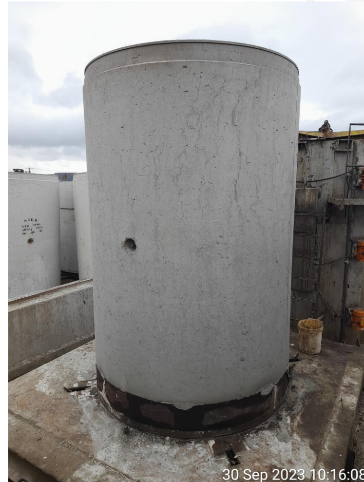
Après démoulage, durcissement avant manutention
