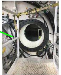
Roue de coupe accessible, pressurisable. Accès via shuttle
