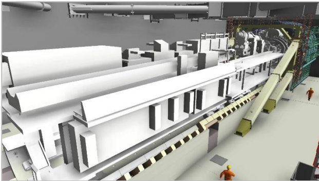
Etape 3 : Ripage du bouclier + R1 en cloche pour générer l'espace de montage de la R2
